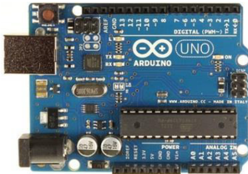
Figura 6: Arduino UNO R3
