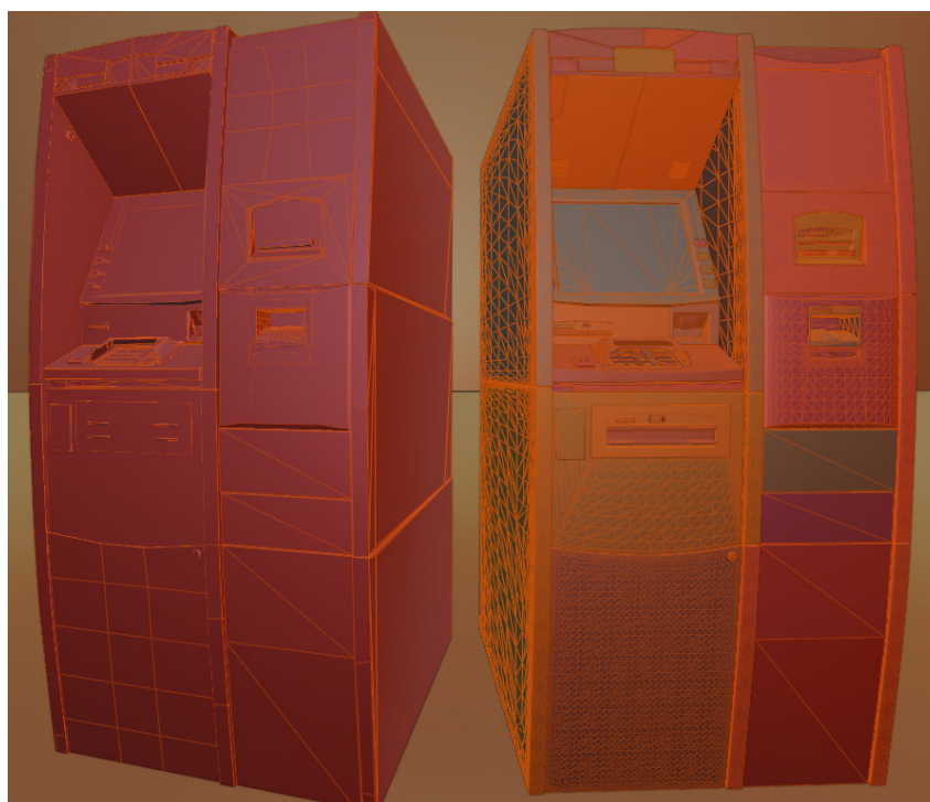
Figura 36 – Modelo de caixa eletrônico otimizado à esquerda e original à direita
