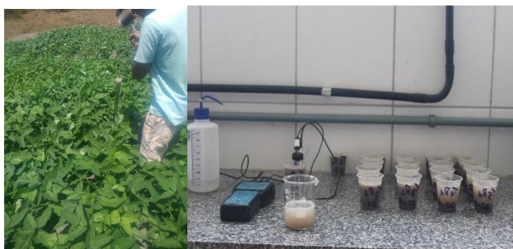
Figura 4. Coleta e verificação da condutividade elétrica do extrato da saturação do solo.
