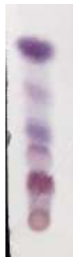
Figura 5 – Cromatograma obtido por CCD de extrato hidroetanólico da geoprópolis de Melipona fasciculata Smith de Pinheiro
