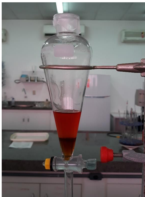
Figura 5 – Separação entre as fases microemulsionada e bio-óleo não solubilizado.
