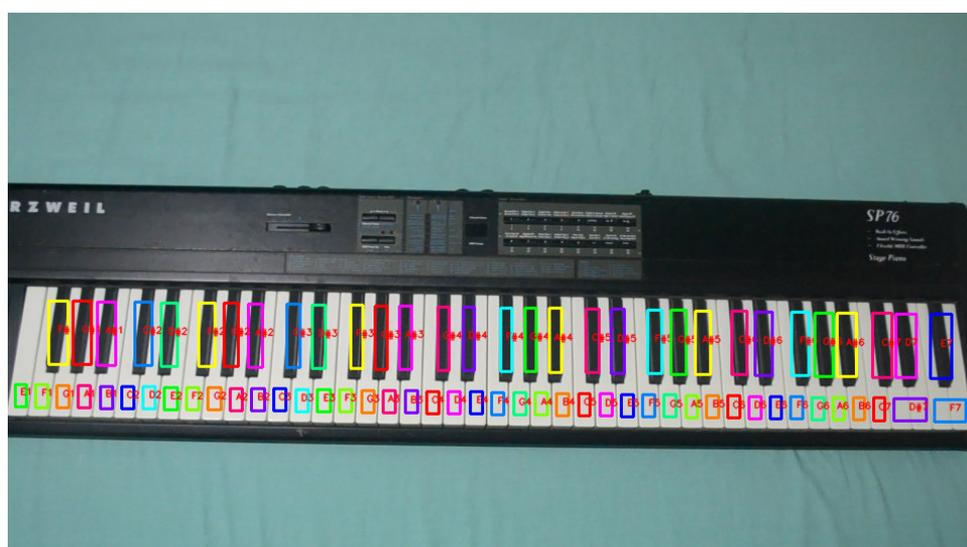
Figura 38 – Detecção de teclas em um KURZWEIL SP76.
