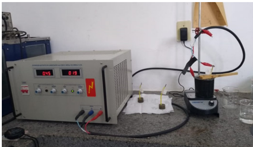
Figura 3 – Montagem experimental do ensaio de Eletrodeposição.
