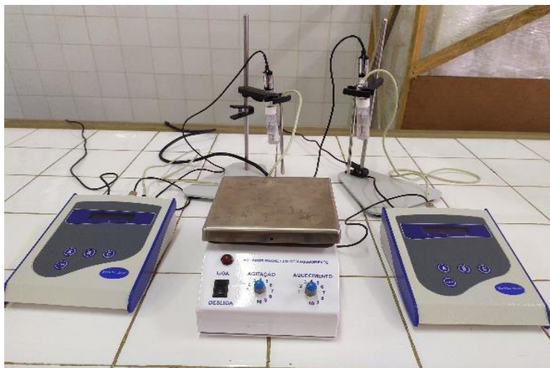
Figura 7 –pHmetros e agitador magnético utilizados no procedimento experimental.
