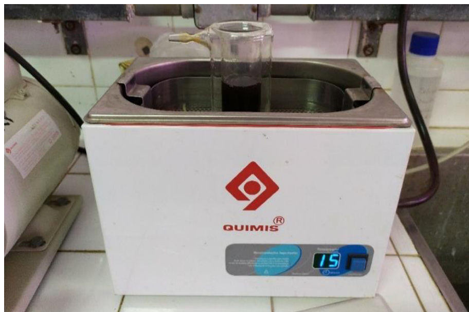
Figura 6- Banho ultrassônico utilizado no procedimento experimental.
