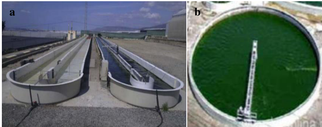
Figura 2 - Sistemas de tanques abertos – raceway (a); Lagoa circular com agitação (b).
