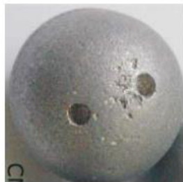
Figura 8– Ataque por pite em bola de ferro fundido branco de alto cromo
