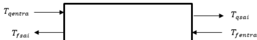
Figura 5 – Trocador de calor com escoamento puramente contracorrente
