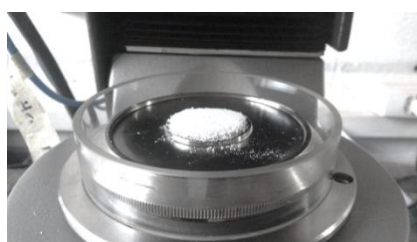
Figura 9 - Corpo de prova de 1 mm de espessura e 35 mm de diâmetro entre as placas do reômetro
