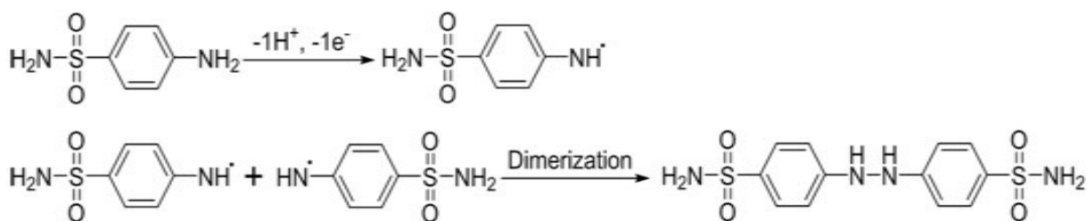
Figura 14: Mecanismo de oxidação da sulfanilamida.
