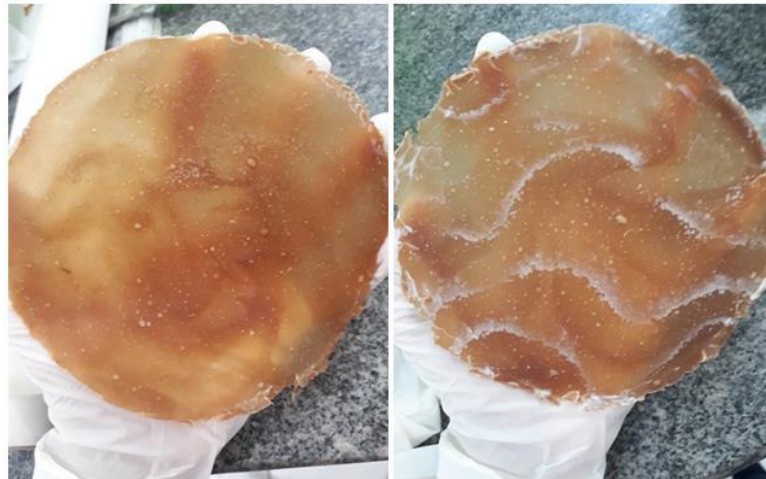
Figura 3- À esquerda, biofilme de formulação 1. À direita, biofilme de formulação 2. Ambos após secagem.
