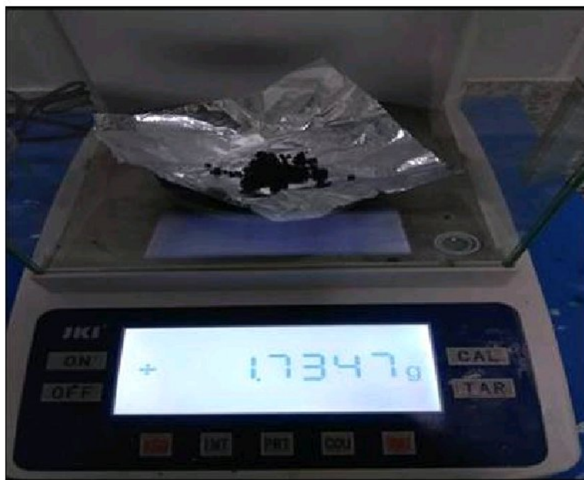
Figura 10 - Balança utilizada para a pesagem dos nitratos de zinco e cromo e hidróxido de sódio
