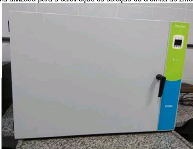
Figura 14 - Estufa utilizada para a calcinação da solução de cromita de zinco
