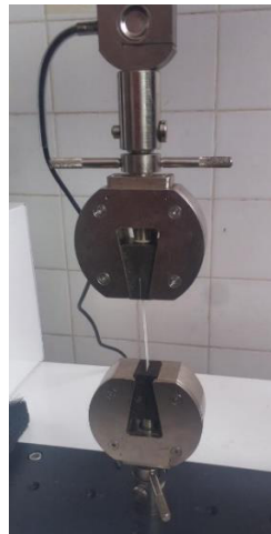
Figura 10- Máquina universal de ensaios BIOPDI em operação
