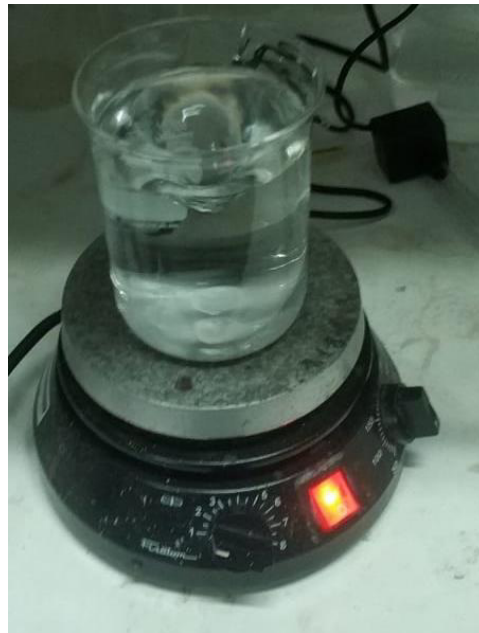
Figura 11 - Teste de intumescimento dos nanocompósitos
