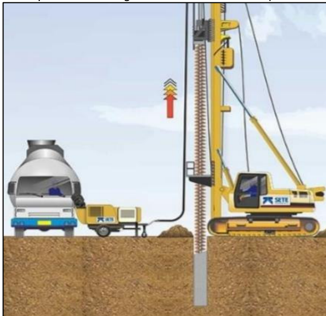
Figura 16: Etapa de concretagem do fuste da estaca tipo hélice contínua.
