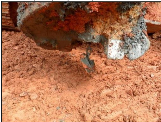
Figura 14 - Detalhe da tampa de proteção recuperável na extremidade inferior do trado.
