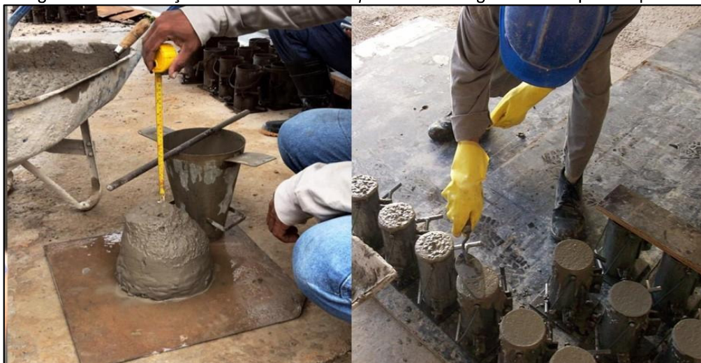
Figura 15: Realização do ensaio de slump test e moldagem dos corpos de prova.
