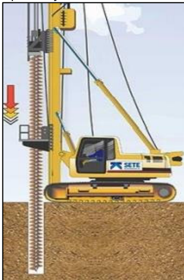
Figura 12: Etapa de perfuração da estaca hélice contínua monitorada.
