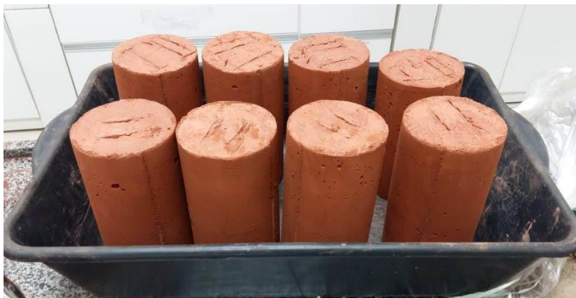
Figura 10 - Corpos de Prova com composições de 30% e 50% de RB
