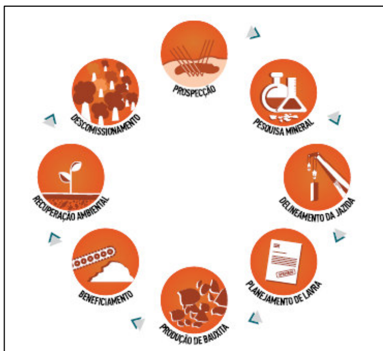
Figura 1 - Ciclo de vida de uma jazida de bauxita
