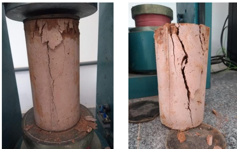
Figura 14 - Corpos de prova em ensaio de compressão uniaxial e após o rompimento
