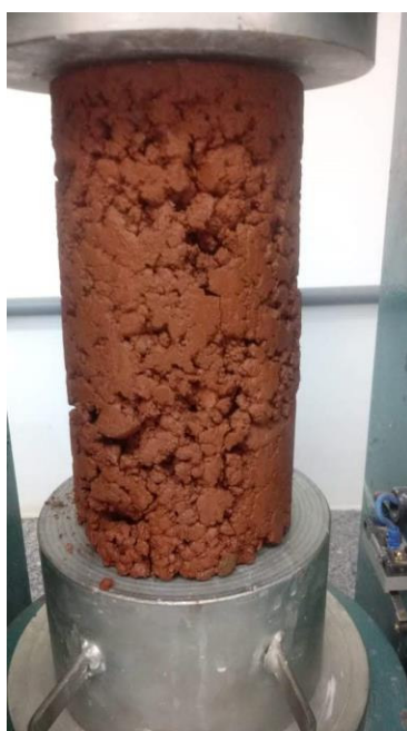
Figura 12 - Corpo de prova com composição de 60% de RB
