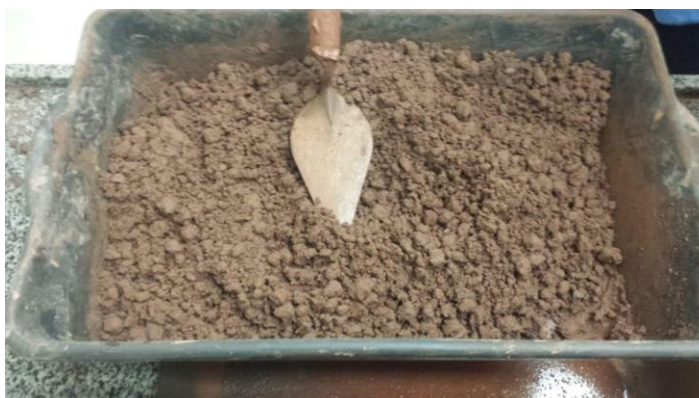
Figura 6b - Confeção manual do concreto com RB
