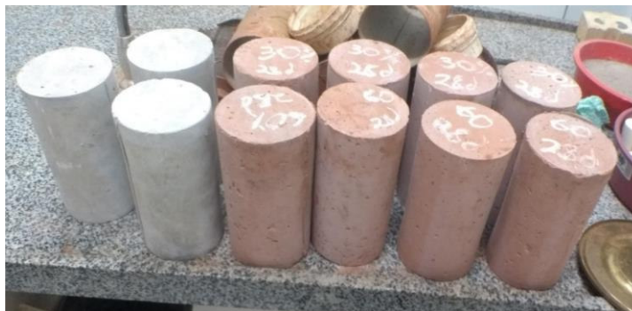
Figura 13 - Corpos de Prova 10 x 20 cm com composição de 0%, 30% e 60% de RB com CP II-E-40
