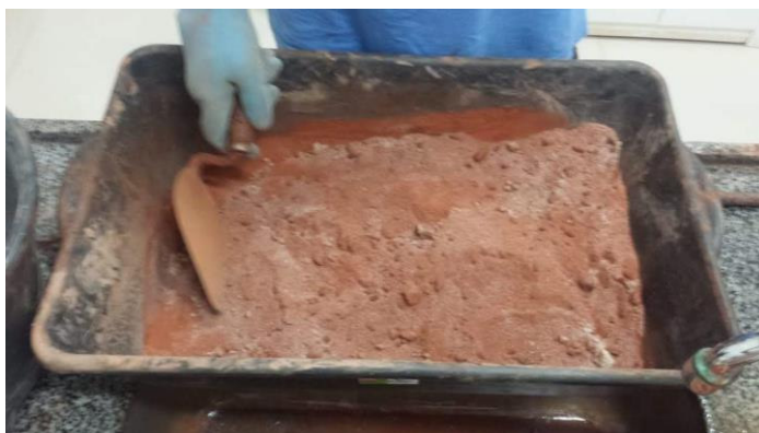
Figura 6a – Confeção manual do concreto com RB
