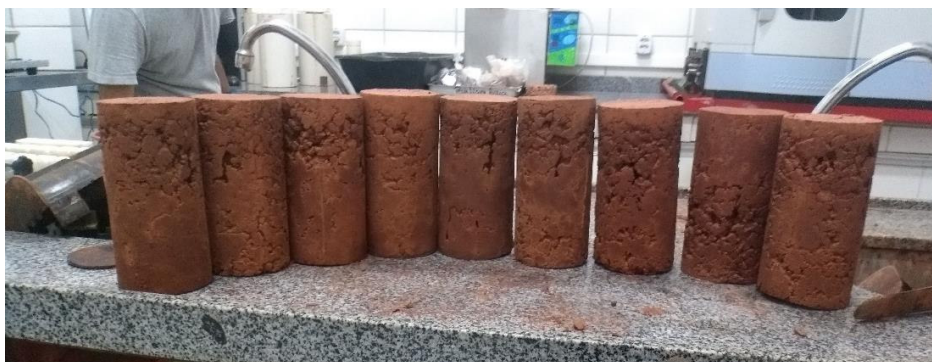
Figura 11 - Corpos de prova com composição de 60% de RB
