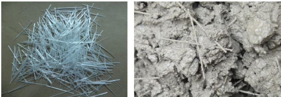
Figura 5: À esquerda, pequenos filamentos de fibra de vidro. À direita, filamentos de fibra de vidro misturados ao concreto.
