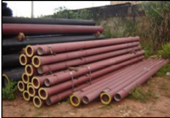
Figura 8 - Tubulação de Ferro Fundido
