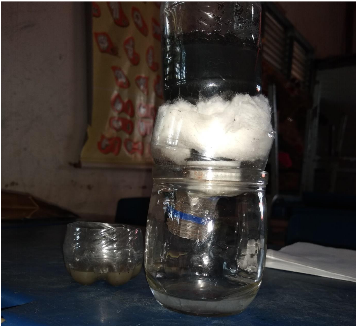
Figura 2 - Sistema de Filtragem com o carvão ativado
