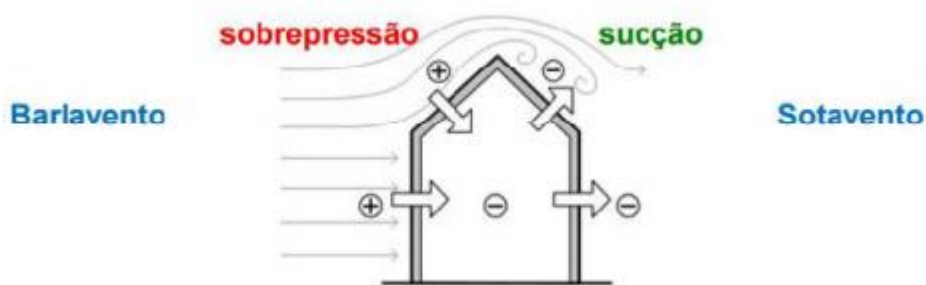
Figura 4 – Ações externas do vento numa estrutura.
