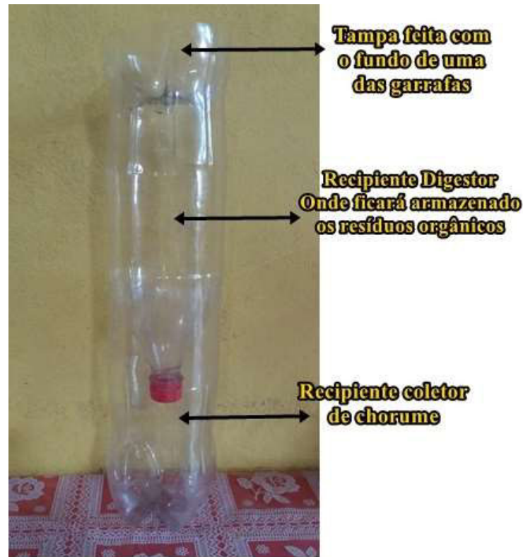
Figura 2: Modelo de composteira feita com tereftalato (PET) utilizado durante a pesquisa
