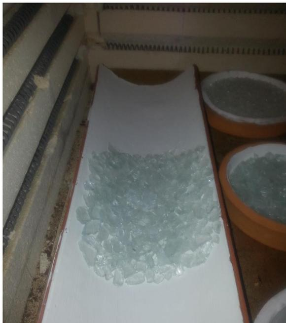
Fig. 19 – Telha com caulim, teste com 1 camadas
