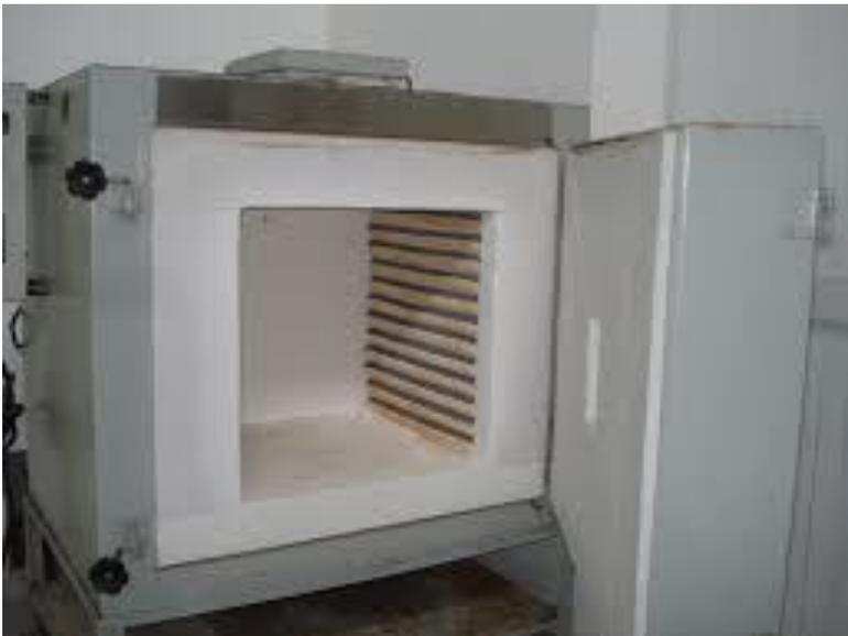
Fig. 16 – Forno de cerâmica
