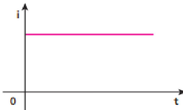
Figura 12 - Gráfico da corrente contínua constante
