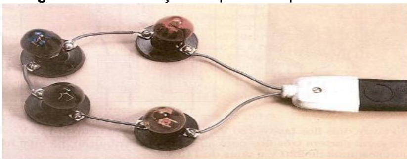
Figura 30 - Associação de quatro lâmpadas em série
