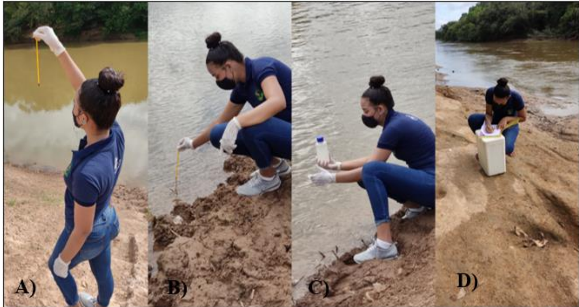
Figura 6. A) Aferição da temperatura do ar; B) Aferição da temperatura da água; C) Coleta da amostra de água; D) Anotação dos dados referentes às medidas de temperatura in loco.
