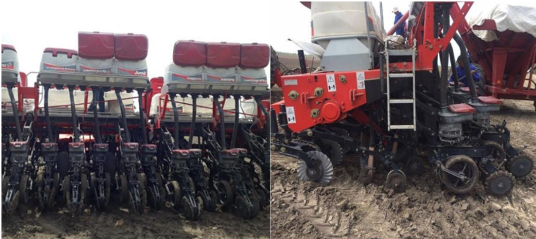
Figura 5. Semeadora-adubadora de precisão com distribuição pneumática, da marca Jumil, modelo JM3080PD Pantográfica e Magnum.
