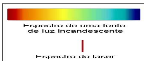
Figura 09. Espectro contínuo e espectro discreto do laser. (BAGNATO, 2001, p. 9)
