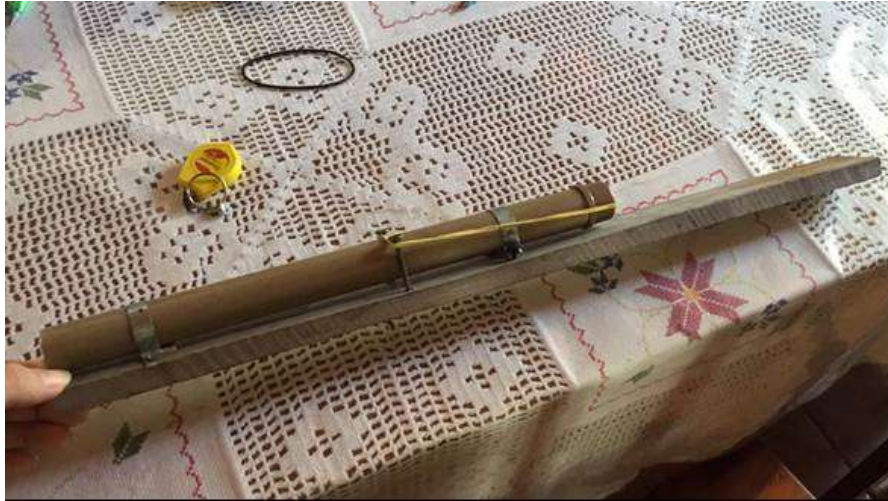
Figura 25 - Catapulta construída com cano PVC, pedaços de madeira, parafusos, abraçadeiras, vedação de 20 mm e elástico.
