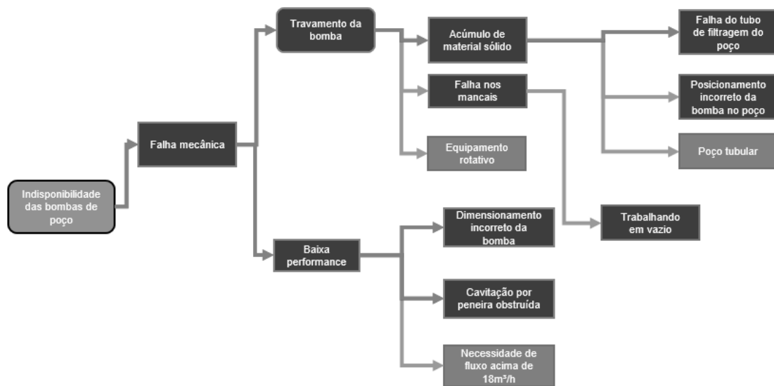
Figura 20 – Fluxograma da Metodologia APOLLO para determinação da Causa Raiz das falhas mecânicas
