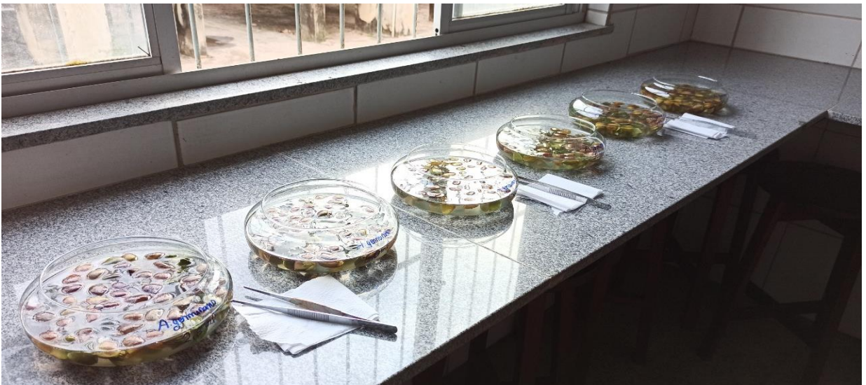
Figura 8. Experimento com propágulos de Avicennia germinans colocados em cubetas estéreis etiquetadas e submetidos a embebição em diferentes percentuais de óleo diesel.
