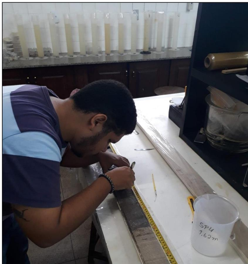
Em laboratório as amostras coletadas tanto na sondagem SPT quanto na sondagem SP foram lavadas com água doce para retiradas de sais e secas na estufa a
