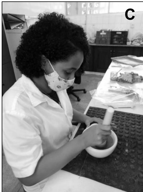
Figura 13 A- Amostra retirada para secagem; B- Sedimento seco e C-Processo de maceração do sedimento. Fonte: Flávia Mochel, 2021.
