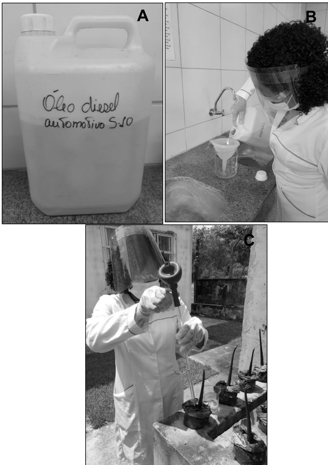
Figura 12 A- ÓD S-10 armazenado em um galão de 5 litros; B- OD sendo transferindo para um béquer; C- Adição do OD direto no sedimento com os propágulos plantados. Fonte: Flávia Mochel, 2021.
