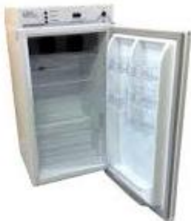
Figura 7- Estufa incubadora B.O.D, utilizada na análise de degradação das amostras.
