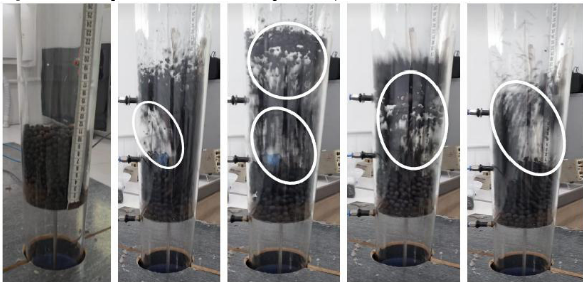
Figura 26 - Comportamento do carvão vegetal de açaí com altura de 10cm no leito fluidizado.
