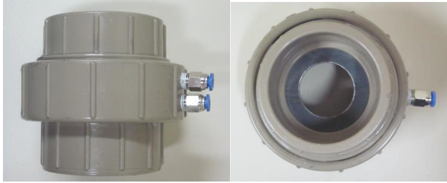
Figura 48 - Placa de orifício com suas tomadas de pressão diferencial
