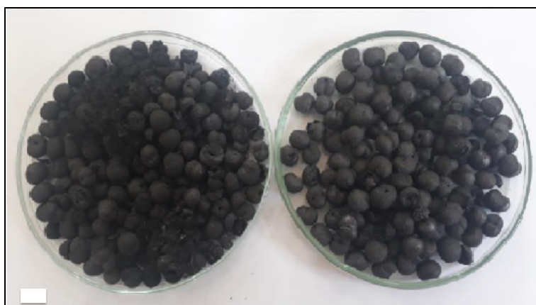
Figura 7 – Carvão vegetal de açaí obtido a 350°C (esquerda) e 400°C (direita)
