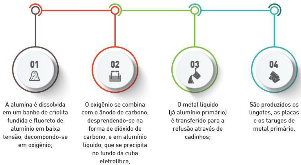
Figura 7 – Diagrama de blocos do Processo Hall-Héroult. Fonte: ABAL, 2019.
