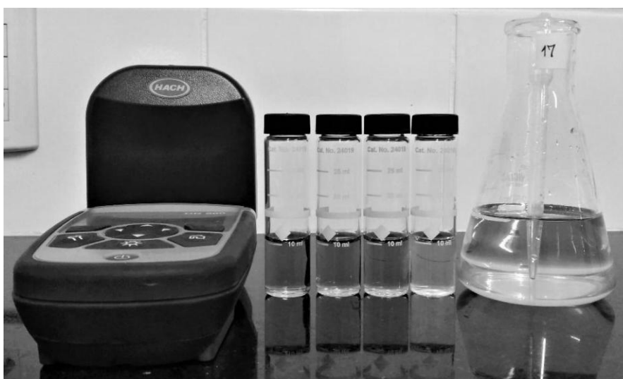
Figura 8 - Leitura dos resultados em triplicata no equipamento DR900
