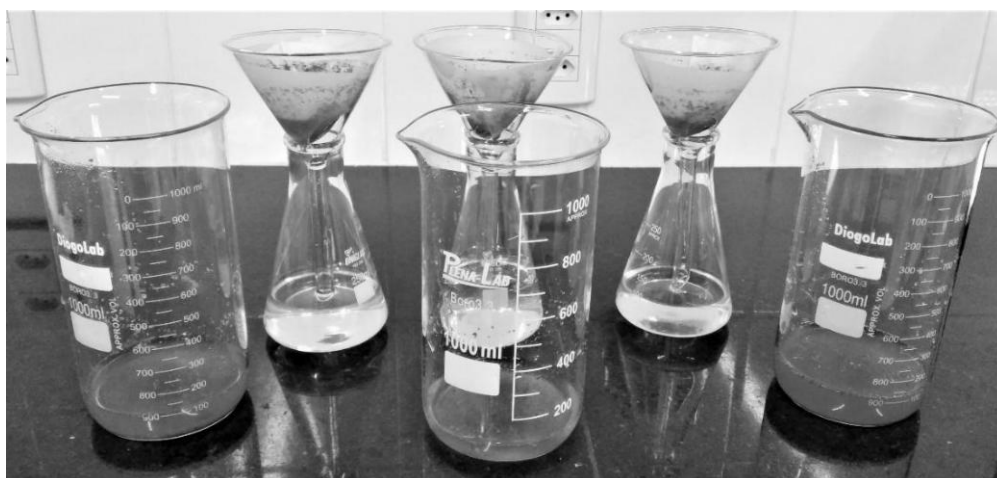
Figura 7 - Processo de filtração das fibras de coco após ensaio
