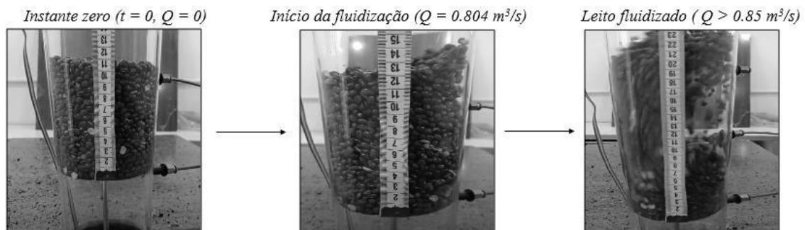
Figura 18: Comportamento do leito contendo feijão em função do tempo.
