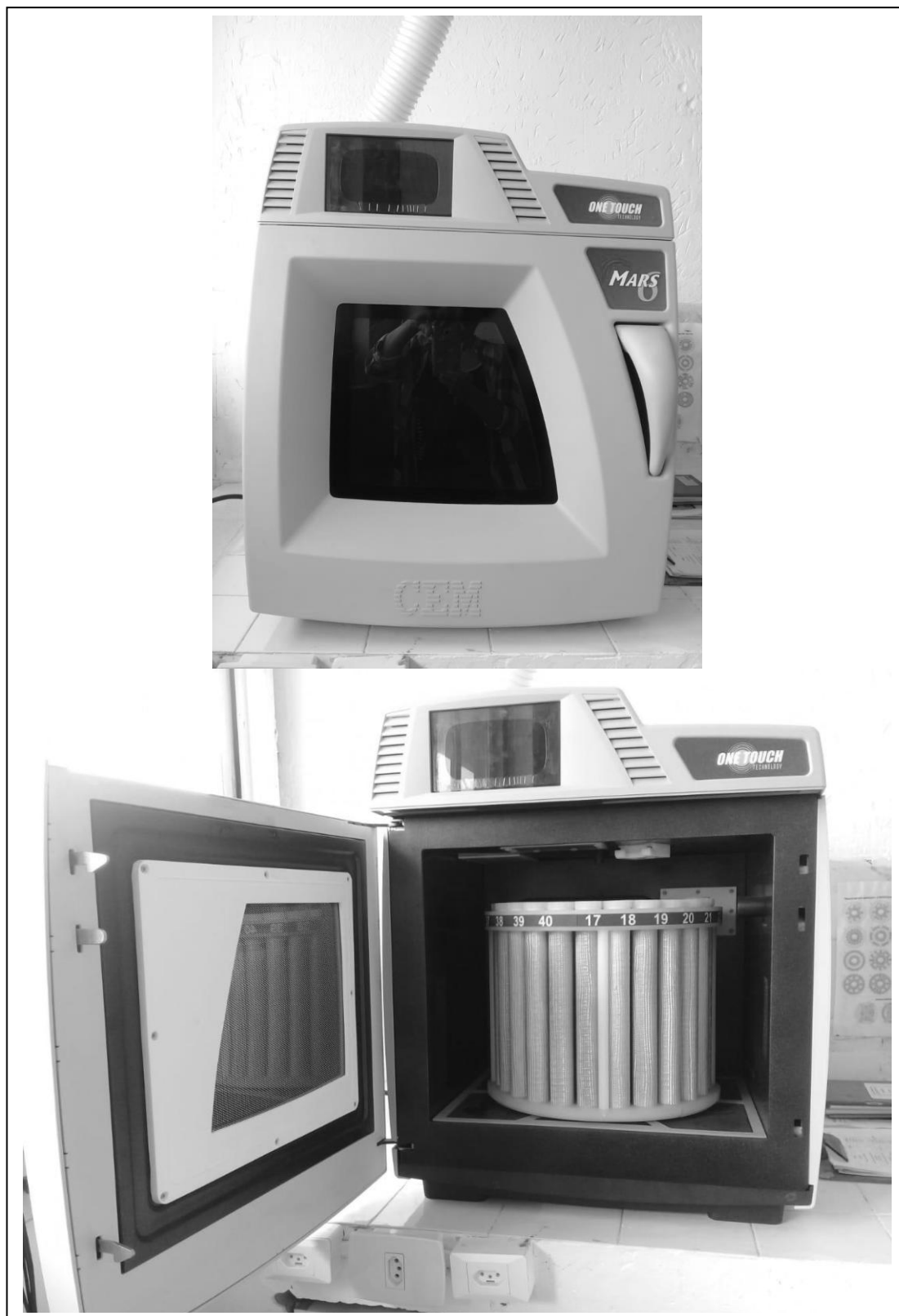
Anexo A1 - Fotos do forno micro-ondas usado na extração dos minerais das amostras de frutos amazônicos. Destaque dado ao carrossel contendo os vasos de Teflon.
