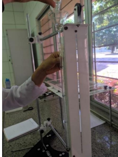
Figura 16- Adaptação do viscosímetro de Stokes preenchida com amostra de álcool em gel.
