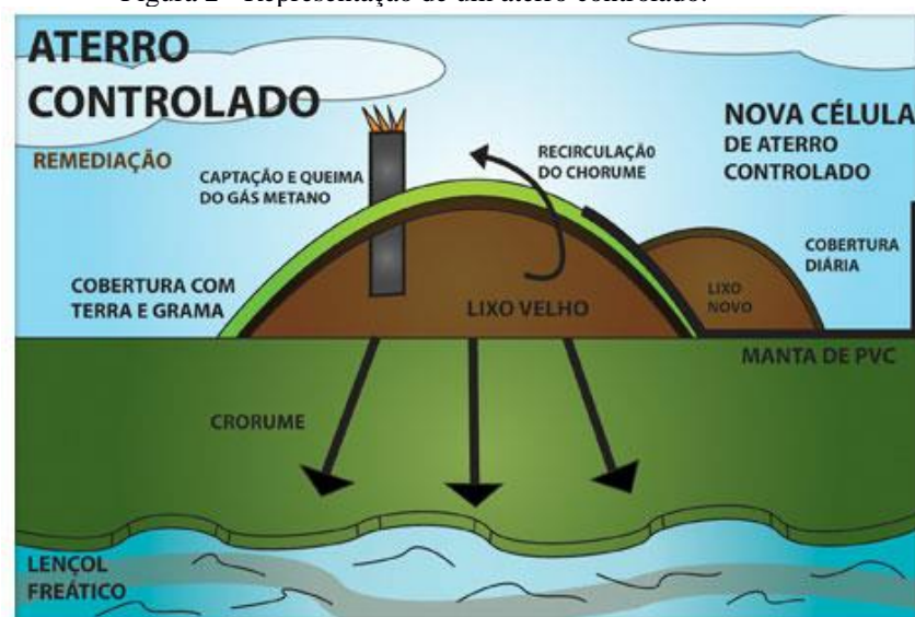
Figura 2 - Representação de um aterro controlado.
