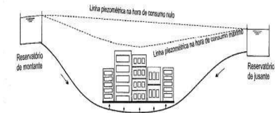
Figura 3 - Desenho esquemático típico de um reservatório de montante.
