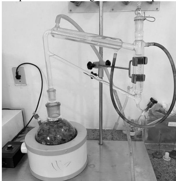
Figura 9- Aparelho de Clevenger contendo capim citronela.
