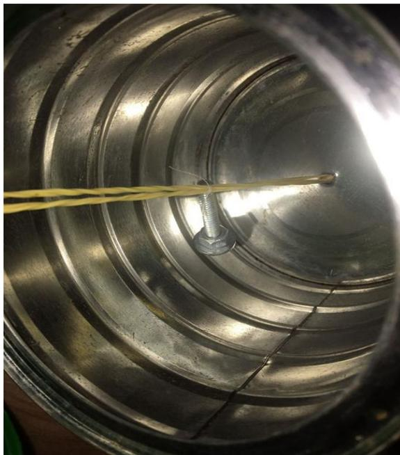
(Fig.01. Encaixe do elástico nos furos juntamente com o parafuso amarrado a linha)
