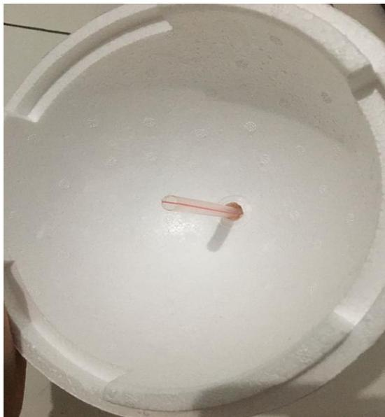
(Fig.01. O furo da parte de cima da esfera junto com a introdução do canudo)
