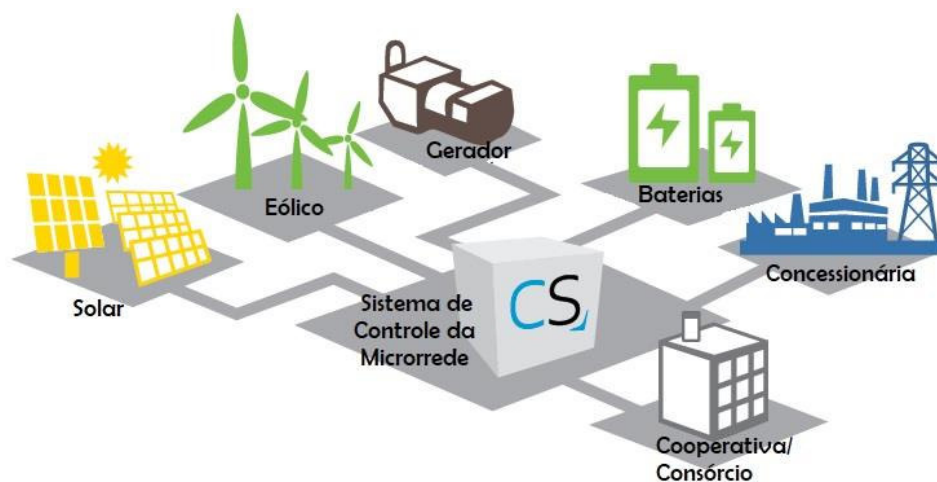
Figura 2 - Exemplo de sistema de microrrede. Adaptado de (MICROGRID, 2021).
