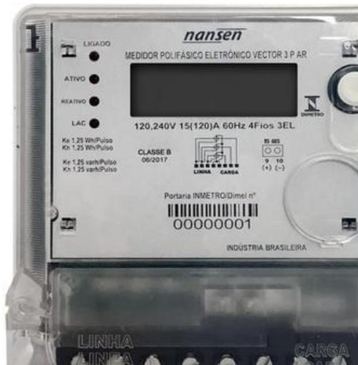
Figura 6: Exemplo de medidor bidirecional.
