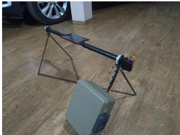
Figura 28: Foto protótipo seguidor solar completo.
