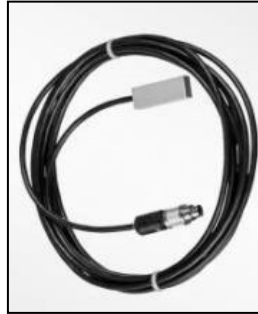
Figura 2.16 - Termômetro Instalado junto ao Módulo Fotovoltaico
