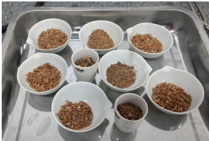
Figura 6: Material após incineração.
